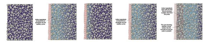
مواد کریستال شونده به صور مختلف قابل مصرف هستند. فرم مایع آن به عنوان افزودنی آببند کننده بتن استفاده شده و به مخلوط بتن در حین پروسه بچینگ پلانت و یا به تراک میکسر مجهز در سایت افزوده می شود. فرم پودری آن بصورت پاشش خشک بر سطوح بتنی افقی تازه و یا بصورت مخلوط با آب به عنوان پوشش بر سطوح بتنی قدیمی و جدید ( اعم از افقی و یا عمودی ) قابل مصرف است.
